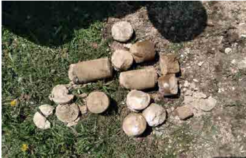
• Рисунок 7. Образцы пород, отобранные из скважины №2 (керна: глина, известняк, алевролит).
